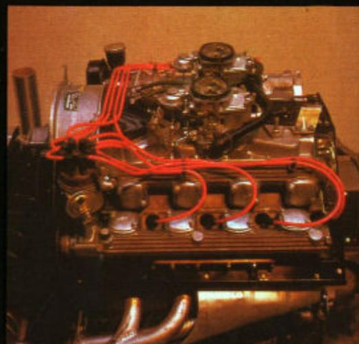
– vzduchem chlazený motor vzadu v samonosné karosérii. T 613 potvrzuje přesvědčivým způsobem, že uložení motoru nad zadní nápravu bylo dosaženo velmi dobrých a u klasických automobilů nedosažitelných vlastností:
